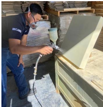
Figura 23. Pintado la estructura.
