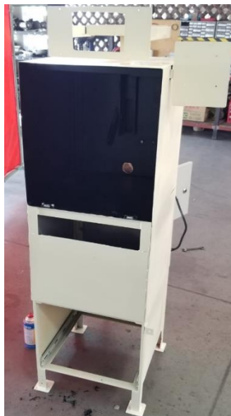
Figura 24. Estructura pintada y soldada
