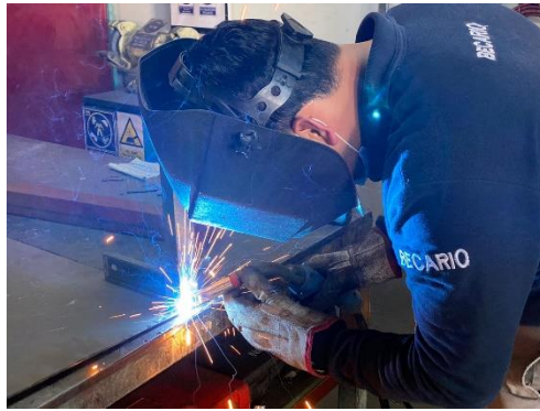
Figura 22. Proceso de soldado para estructura.
